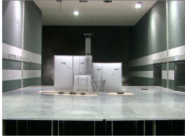
Figure 2 : Maquette en soufflerie climatique Jules Verne
