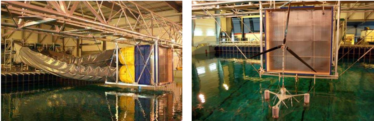
**Figure 13 : Réalisation du système de soufflage de simulation du vent off-shore sur le bassin de houle de l'Ecole centrale de Nantes, et test de qualification de la maquette d'éolienne flottante dynamiquement semblable**
