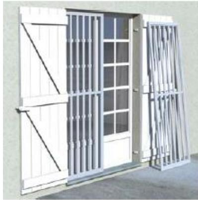
Figure 21 : grille anti intrusion associée à la stratégie « wet-proofing » (source DGALN, 2012)
